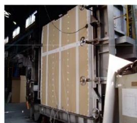
間仕切り壁155mm 裏面温度は何と31度
